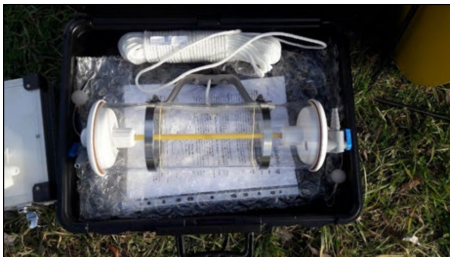
Slika 7. Uzorkivač za mjerenje lebdećeg nanosa u rijekama
