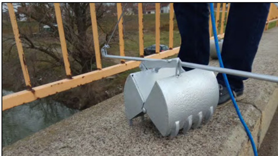
Slika 6. Uzorkivač za mjerenje vučenog nanosa u rijekama
