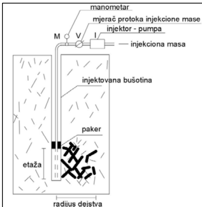
Slika 17. Šema osnovnih elemenata injektiranja (55)
